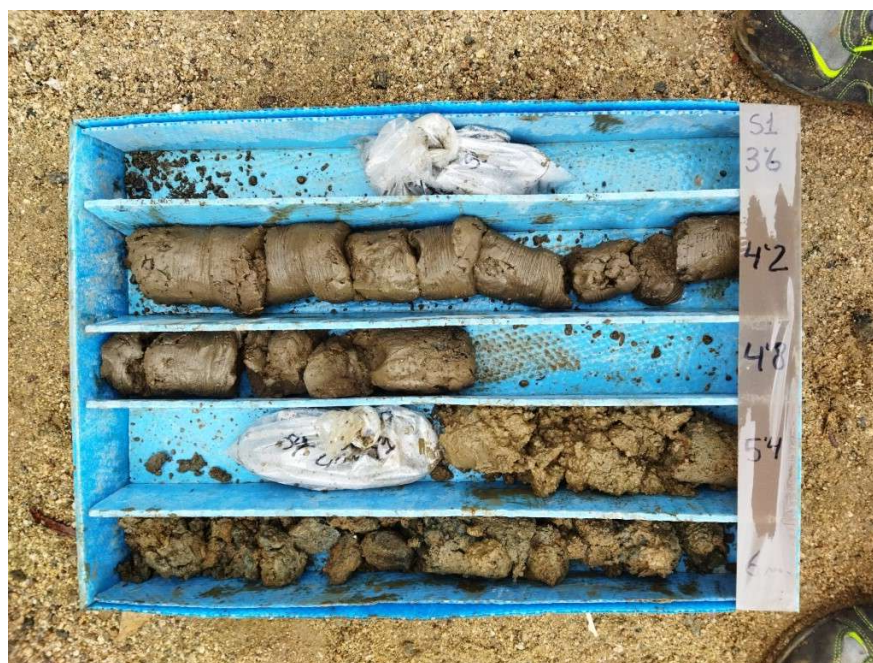
Caixa portamostres corresponent al sondeig (S1) de -3,0 a -6,0 m. de profunditat.
