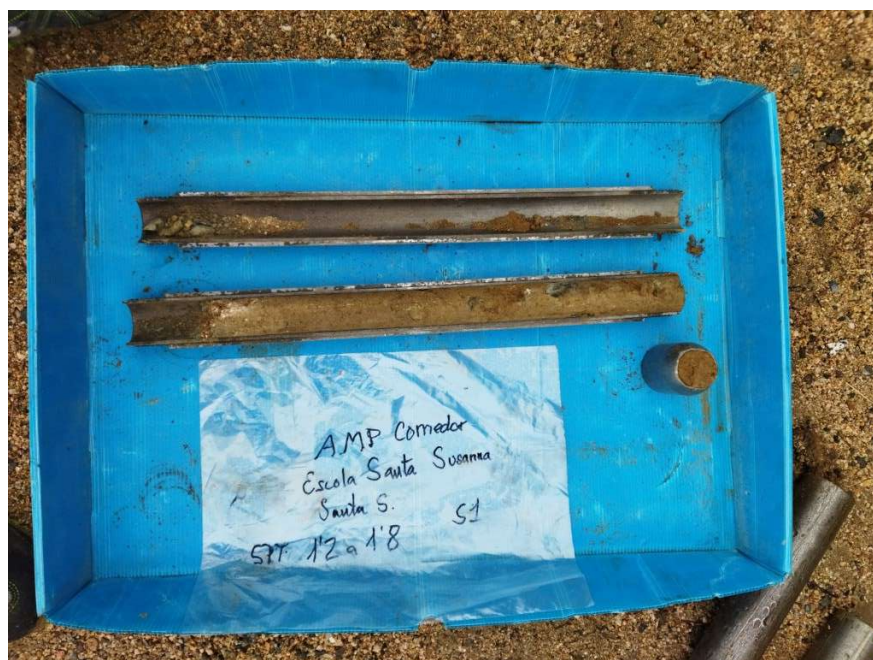
Assaig SPT de -1,2 a -1,8 m. de profunditat en sondeig (S1)
