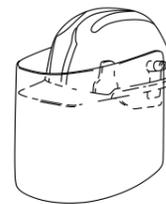
CASCO DE SEGURIDAD con pantalla antiproyecciones
